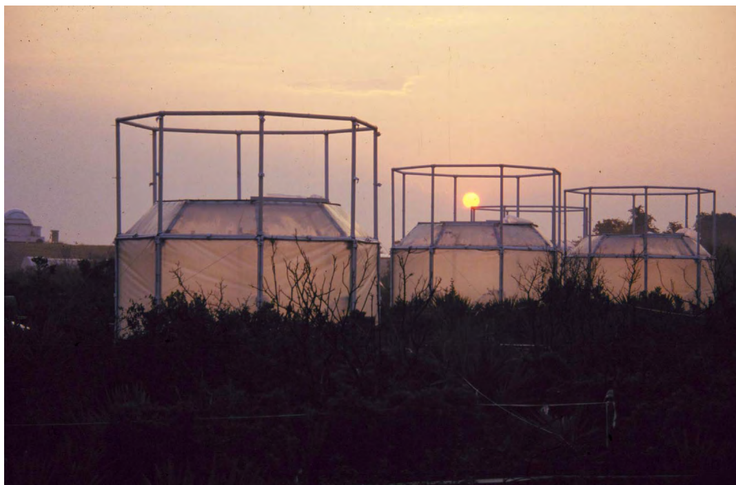
EXPERIMENTOS CONTROLADOS: Una de las formas de estudiar la respuesta de los ecosistemas al enriquecimiento del \text{CO}_2 atmosférico consiste en inyectar el gas en cámaras abiertas que rodean un fragmento de vegetación.
